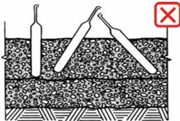
भाइब्रेटर छड्के आसनमा छ र अधिल्लो पत्रमा राम्रोसँग घुसेको छैन
