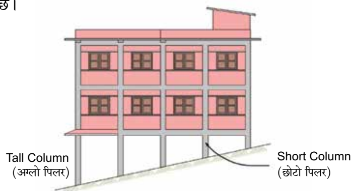
भिरालो जमिनमा बनेको भवन
